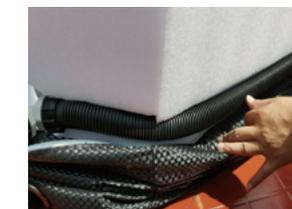
10) Insérez le tuyau dans la rainure de la mousse, comme illustré sur le schéma.
