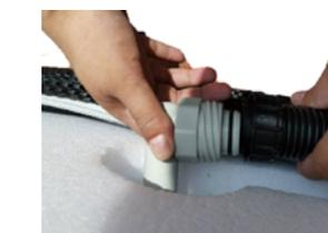
11) Raccordez l'autre extrémité du tuyau au connecteur bidirectionnel, comme illustré sur le schéma.
